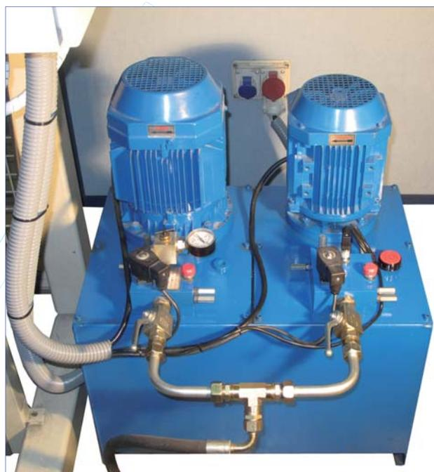
Figura 17. Central Hidráulica.
