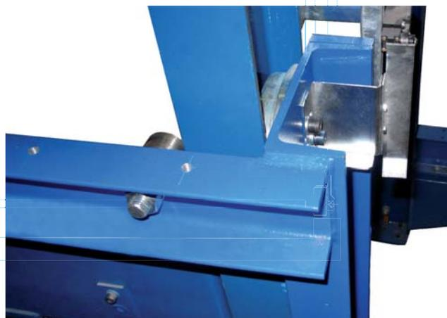
Figura 6. Guiado Lateral, 4 rodamientos por cada chasis.
